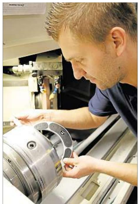
Mechaniker Sebastian Neubauer von Koch Maschinenbau bearbeitet einen Schneidstempel an einer Schleifmaschine.
